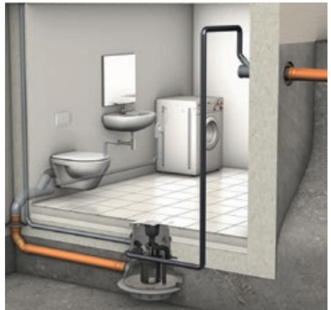
43 Funktionsprinzip einer Hebeanlage
