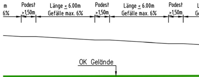
→ Rampen der neuen Neckarbrücke werden ca. 80 bis 100 m lang.
