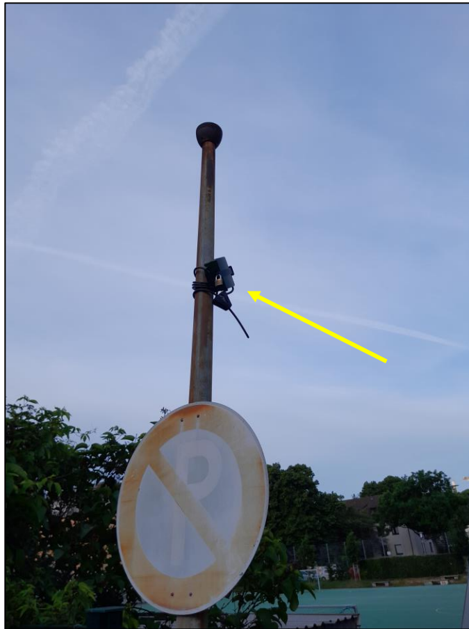
Foto 6: Akustische Dauer- erfassung (Song Meter Mini Bat) südöstlich des Gebäudes auf dem Schulhof.
